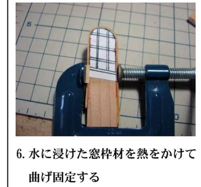
6. 水に浸けた窓枠材を熱をかけて曲げ固定する
