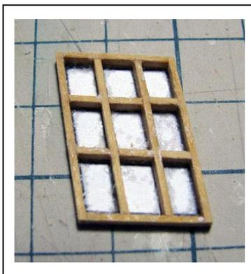
窓枠の縦外棧の余分な所を切り落とします。この時、低粘度タイプの瞬間接着剤を窓枠全体にしみ込ませると接着強度が上がります。左写真ボンド、アロンアルファ・プロ用No.1 低粘度のサラサラタイプです。右写真は瞬間接着剤をしみ込ませた状態。
