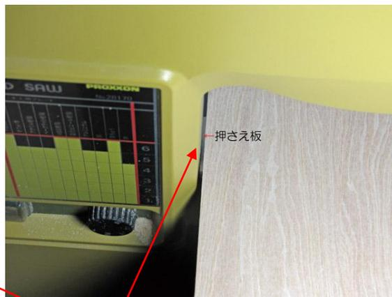
上写真は板テーブルを裏向きのままアルミテーブルに乗せて固定用板①が本体と鋸刃にきっちり収まるか見ます。上右写真は板テーブルを正規に乗せた時にキッチリ収まらない時は押さえ板（固定用板①）を削って調整をし、板テーブルが緩まないようにして固定します。
